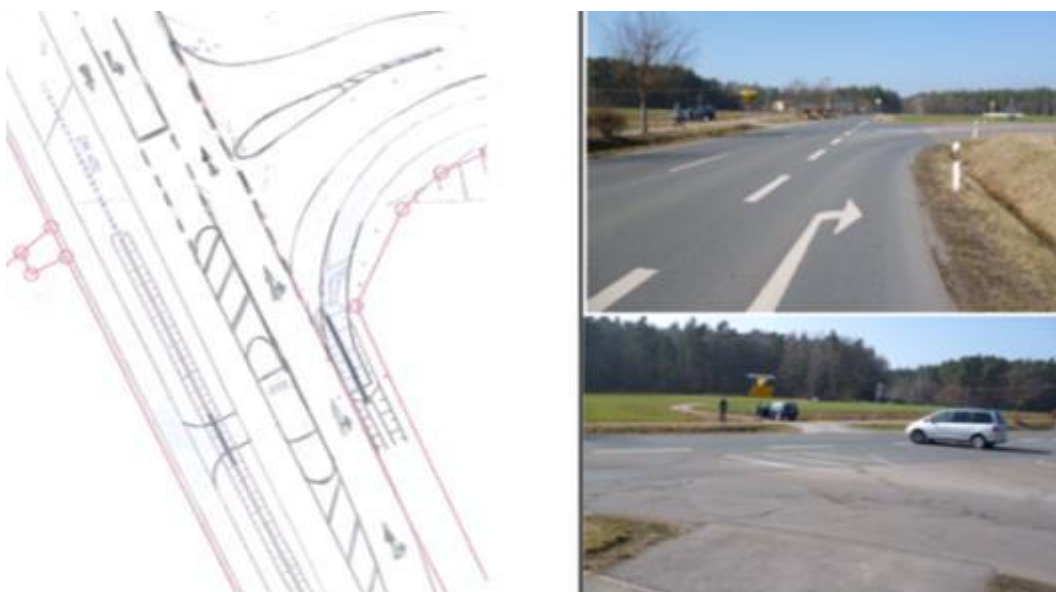
Abb.: Umbauvorschlag mit Darstellung der Querungsmöglichkeit
