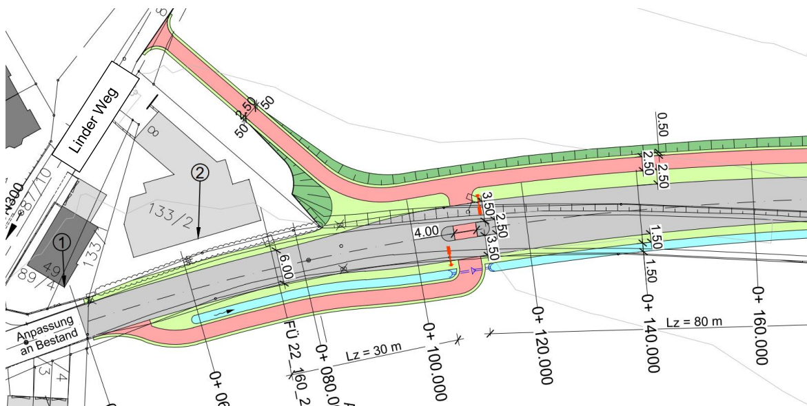
Querungshilfe am Ortseingang von Weitersdorf
